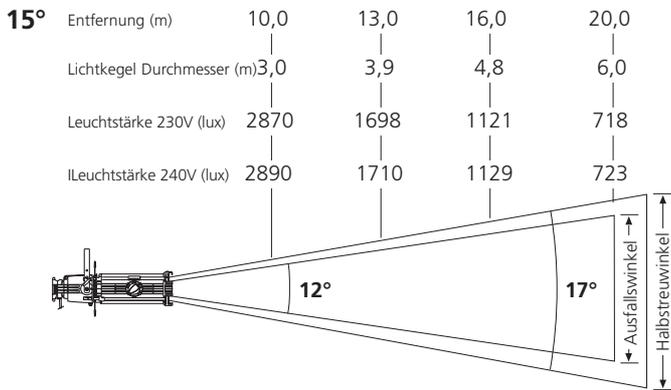
Halbstreuwinkel: Durchmesser des Lichtkegels: Multiplizieren Distanz mit 0,30
