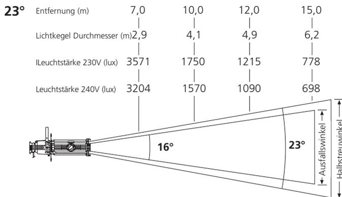
Halbstreuwinkel: Durchmesser des Lichtkegels: Multiplizieren Distanz mit 0,41
