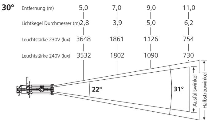
Halbstreuwinkel: Durchmesser des Lichtkegels: Multiplizieren Distanz mit 0,56
