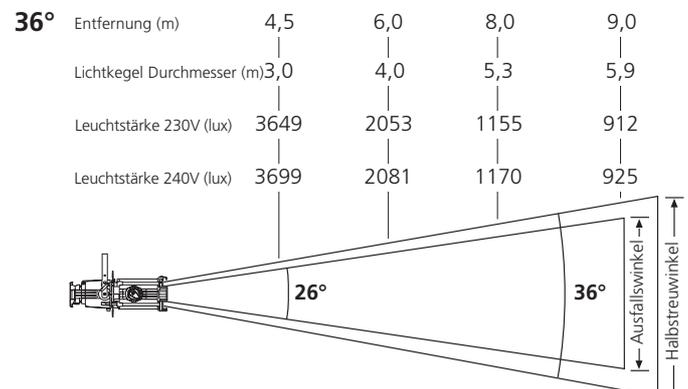
Halbstreuwinkel: Durchmesser des Lichtkegels: Multiplizieren Distanz mit 0,66
