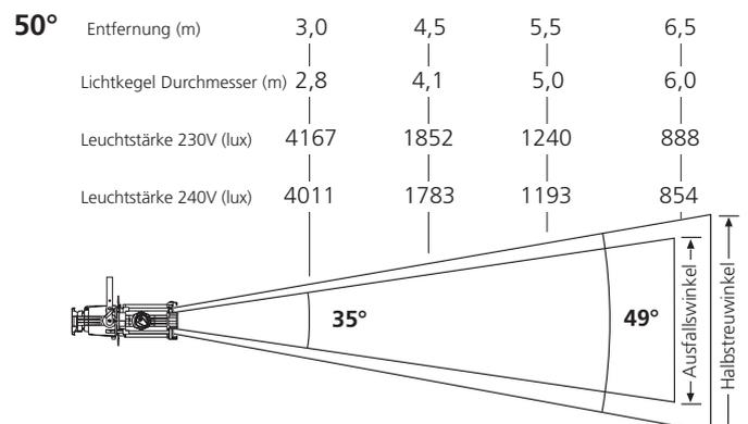
Halbstreuwinkel: Durchmesser des Lichtkegels: Multiplizieren Distanz mit 0,92
