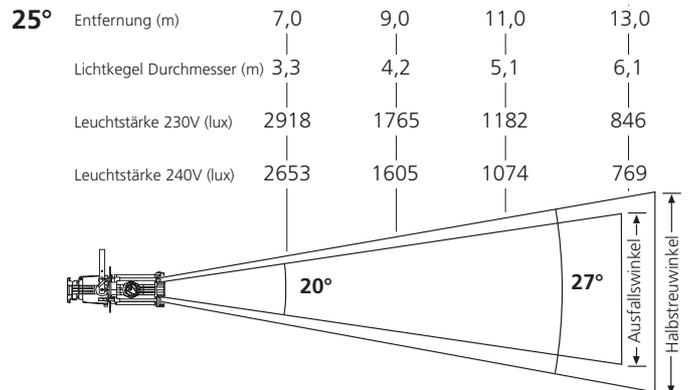
Halbstreuwinkel: Durchmesser des Lichtkegels: Multiplizieren Distanz mit 0,47
