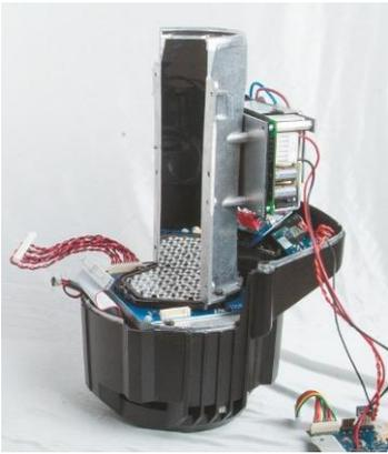
**LED-Platine** Eine abgenommene Kaleidoskop-Seite gibt den Blick auf die LED-Platine mit dem aufgesetzten Kollimator frei
