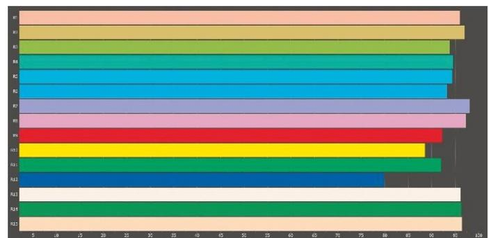
Farb- und R9 Werte bei 3.200K und bei 5.600K werden diese noch deutlich besser
