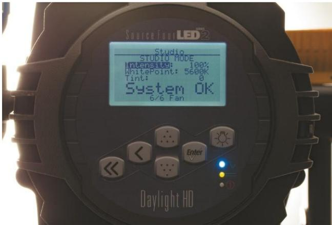
**Studio** einer der verschiedenen Modi, die das direkte Bedienen am Gerät erlauben
